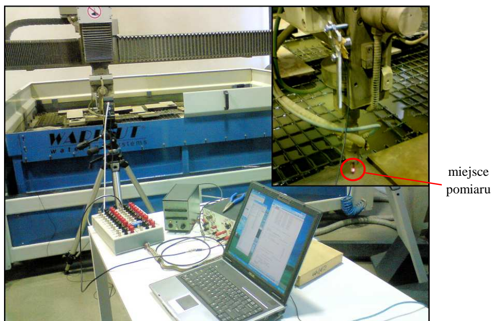
Rys. 5. Schemat stanowiska do pomiaru i rejestracji drgań głowicy z zastosowaniem wibrometru laserowego Fig. 5. The stand for vibration acquisition of cutter head by the laser vibrometer
