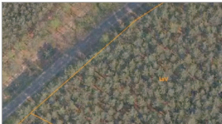
Rys. 4. Niewłaściwa lokalizacja zasięgu koron drzew na ortofotografii wynikająca z technologii jej generowania opartej o NMT (żółta linia – wektor EGiB).
