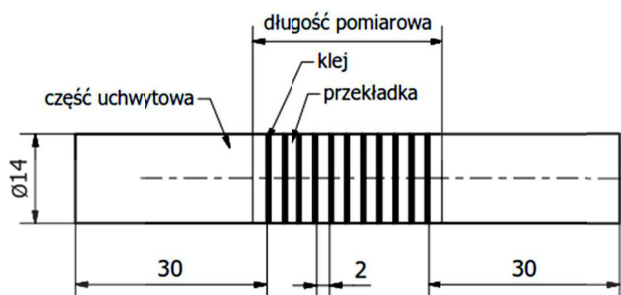
Rys. 5. Próbkę doczołowa umożliwiającą pomiar 11 warstw kleju, zalecana przez rosyjską normę OCT 90245-76 [5]
