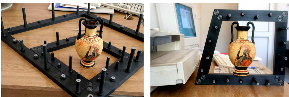
Rys. 2. Usytuowanie amfory względem ramy z osnową zróżnicowaną w trzech wymiarach: oś Z równoległa do wysokości amfory (a) i prostopadła do wysokości amfory (b)
