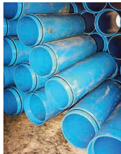
Ryc. 2. Pierwsze polskie krótkie moduły rur PE-MD wykonane przez firmę RenoRurCentrum Sp. z o.o., zastosowane do bezwykopowego powiększenia przewodów kanalizacyjnych w Dębicy w 1993 r.
