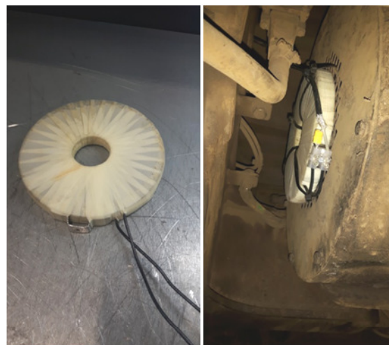
Rys. 8. Widok na cewkę do pomiaru strumienia poosiowego i miejsce jej zainstalowania w badanym silniku napędu wagonu
