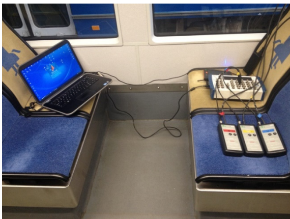
Rys.3. Zestawiony układ pomiarowy do badań diagnostycznych silników indukcyjnym klatkowym w napędach wagonów
