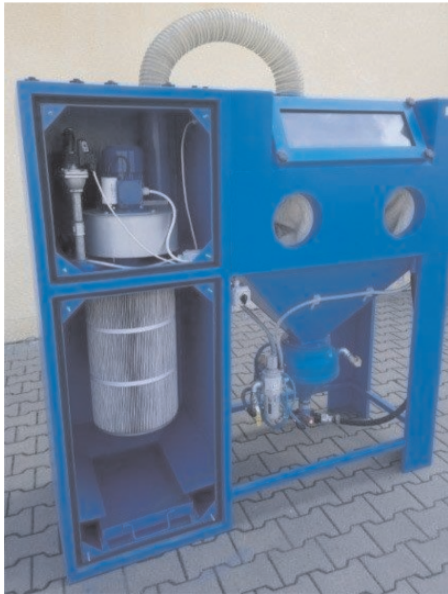
Rys. 8. Ciśnieniowa oczyszczarka kabinowa z odsłoniętym odciąganiem pyłów firmy New-Tech [6]
