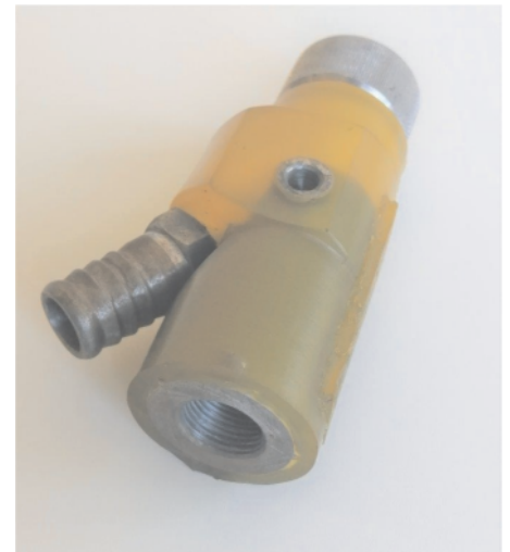
Rys. 9. Pistolet inżektorowy metalowy wraz z dyszą (a) i pistolet z tworzywa sztucznego (b)
