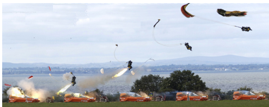
Rys. 1. Fazy katapultowania fotela III generacji ( http://www.martin-baker.com/products )
