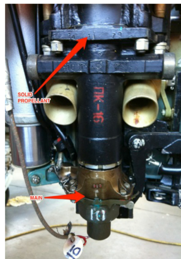
Rys. 3. Dolna część silnika raketowego fotela KM1M z widocznymi dyszami (fot. Draken International, USA)
