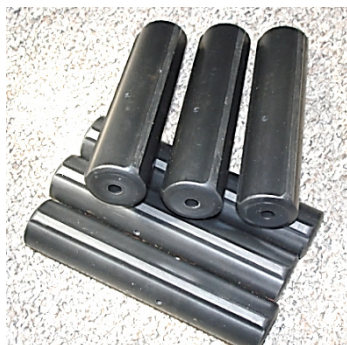
Rys. 12. Ładunki napędowe typu C III do silnika fotela SC-HV00 produkcji AEROFINA S.A. Bukareszt (fot. autorów)
