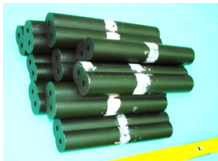
Rys. 8. Ładunki napędowe silnika rakietowego fotela K-36DM (fot. autorów)
