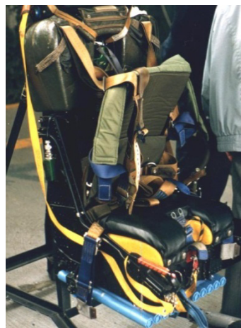
Rys. 11. Wielokomorowy silnik raketowy (górne zdjęcie) fotela Mk7 firmy Martin-Baker umieszczony pod siedzeniem pilota (z prawej) ( http://www.ejectionsite.com )
