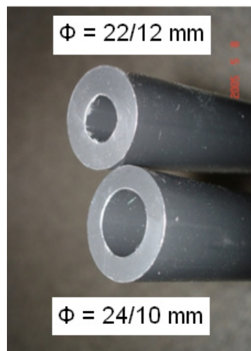
Rys. 5. Powierzchnie czołowe ładunków napędowych: PZM (dolny) i PZMM (fot. autorów)
