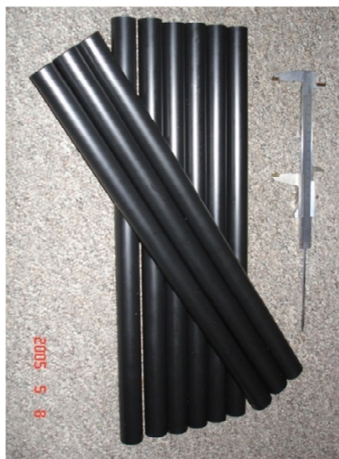
Rys. 4. Ładunki PZMM do silnika fotela KM1M (fot. autorów)
