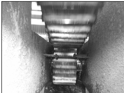
Rys. 4. Kola zębate w układzie napędowym pieca obrotowego
