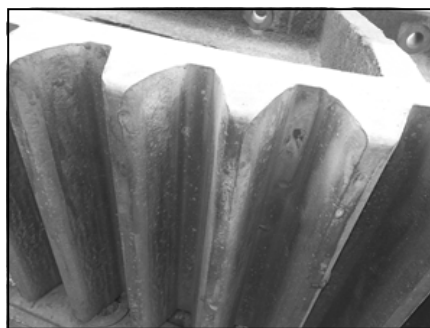
Rys. 1. Fragment wieńca koła zębatego z układu napędowego młyna kulowego po okresie eksploatacji
