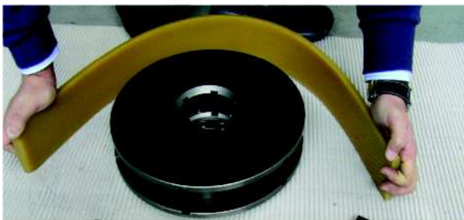
Rys. 5. Element z tworzywa sztucznego stosowany jako wyłożenie turbiny śrutowniczej stosowany do obróbki z zastosowaniem śrutu ceramicznego [4]
