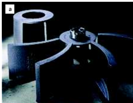
Rys. 14. Wirnik koła rzutowego (a) i turbina śrutownicza (b) z wygiętymi łopatkami firmy Pangborn [7]
