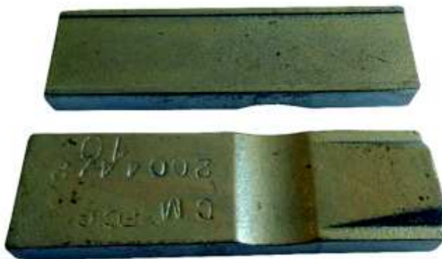
Rys. 11. Łopatki wirnika o średnicy 300 mm: a) widok powierzchni roboczej, b) powierzchnia łopatki z zagłębieniem umożliwiającym zablokowanie za pomocą obrotowych tulei dystansowych
