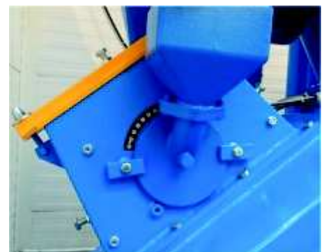
Rys. 2. Turbina śrutownicza zamontowana w oczyszczarce strumieniowej [4]
