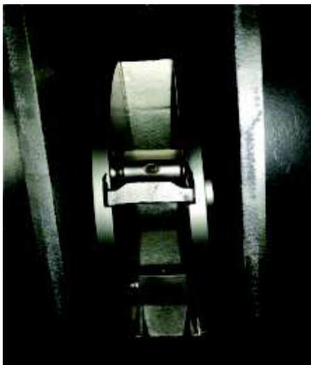
Rys. 12. Widok zespołu koła rzutowego w komorze turbiny śrutowniczej firmy CM [4]
