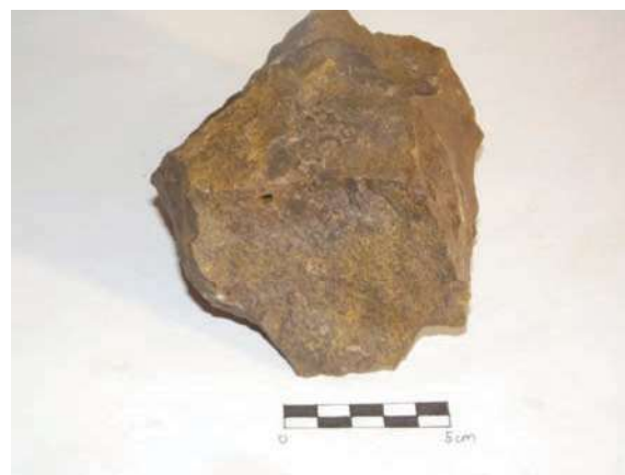
Rys. 4. Dolomit dewoński brunatno-szary D3 (próbka 32) Fig. 4. Devonian, brownish-grey dolomite – D3 type (sample 32)
