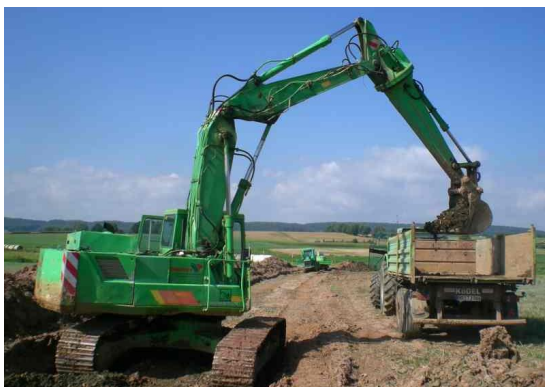
Rys. 12a. Koparka Komatsu PF55L o przestrzennym mechanizmie manipulatora, z członami połączonymi przez przegub o dwóch stopniach swobody [14]
