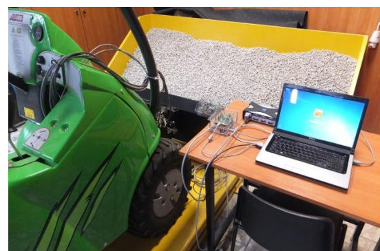
Rys. 7a. Ładowarka Avant 218 podczas badania przydatności modułów AHRS w wyznaczaniu położenia kąтового łyżki względem nadwozia
