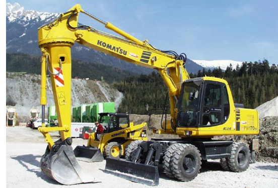
Rys. 12b. Koparka Komatsu PW170ES o przestrzennym mechanizmie manipulatora z członami połączonymi przez przegub o dwóch stopniach swobody [15]
