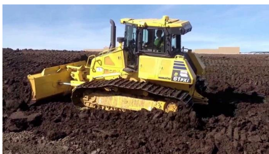
Rys. 6. Spycharka Komatsu D61EXi/PXi-23 wyposażona w seryjnie montowany system automatycznej korekcji lemieszka [8]
