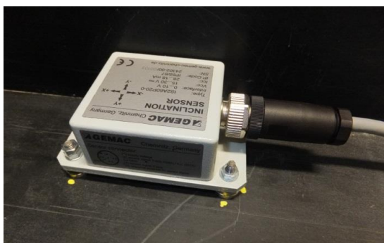
Rys. 14. Elektroniczny inklinometr przemysłowy GEMAC IS2A60P20-0 zamocowany wewnątrz łyżki ładowarki, jako urządzenie referencyjne wykorzystane podczas badań
