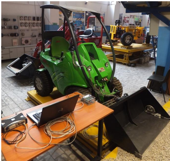
Rys. 7b. Ładowarka Avant 218 podczas badania przydatności modułów AHRS w wyznaczaniu położenia kąowego łyżki względem nadwozia
