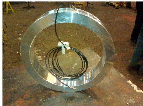
Rys. 5. Cewka Rogowskiego dla generatora 138 MW, 15.75 kV
