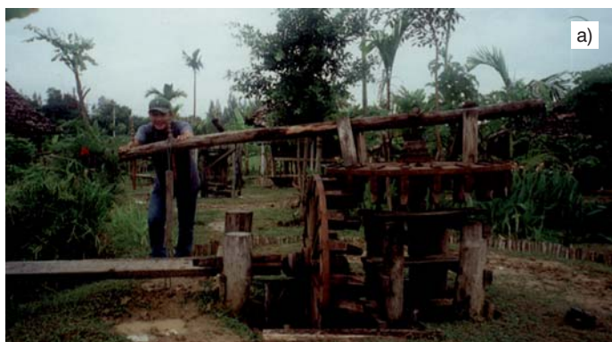
Fot. 7. Urządzenie podnoszące wodę w wiosce na Jawie: a) kierat napędzany siłą ludzkich mięśni, b) koło wodne z bambusowymi czerpakami
