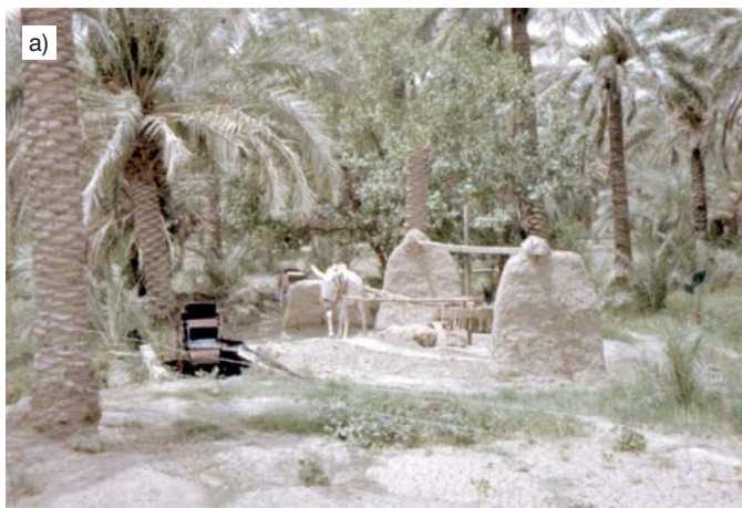
Fot. 1. Urządzenie do przepompowywania wód w kanałach nad dolnym Eufratem: a) widok ogólny „przepompowni”, b) urządzenie napędowe „przepompowni” – kierat ciągnięty przez osła
