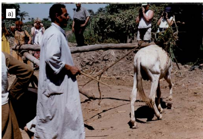
Fot. 2. „Przepompownia” wód nad Nilem w Górnym Egipcie: a) kierat ciągnięty przez muła, b) widok stalowej przekładni
