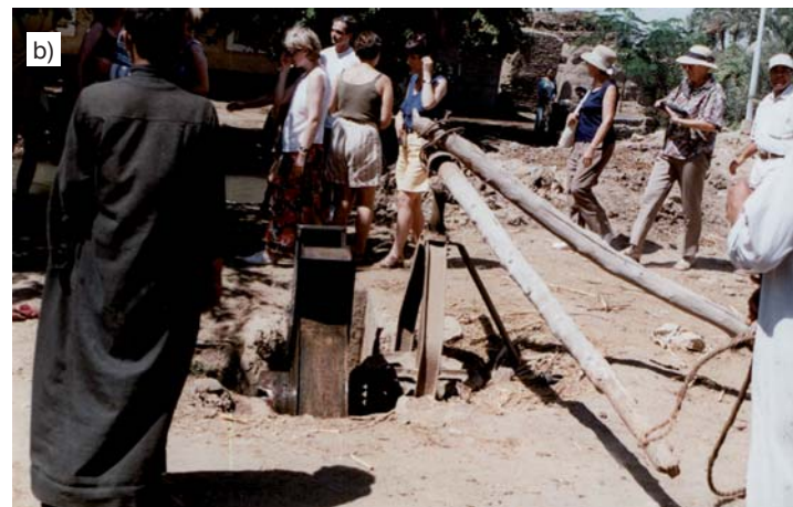
Fot. 2. „Przepompownia” wód nad Nilem w Górnym Egipcie: a) kierat ciągnięty przez muła, b) widok stalowej przekładni
