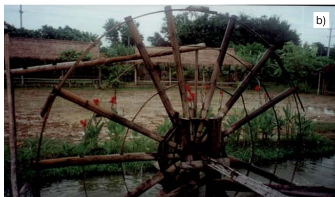
Fot. 7. Urządzenie podnoszące wodę w wiosce na Jawie: a) kierat napędzany siłą ludzkich mięśni, b) koło wodne z bambusowymi czerpakami
