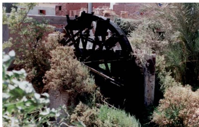
Fot. 4. Urządzenie do podnoszenia wody z kanału w wiosce nad Nilem
