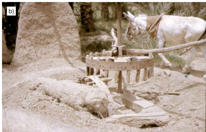
Fot. 1. Urządzenie do przepompowywania wód w kanałach nad dolnym Eufratem: a) widok ogólny „przepompowni”, b) urządzenie napędowe „przepompowni” – kierat ciągnięty przez osła
