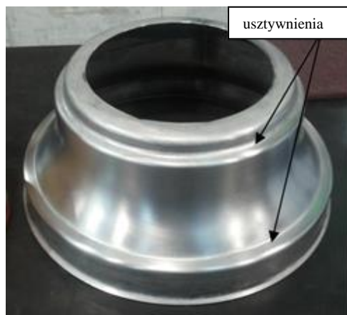
Rys. 2. Osłona łożyska silnika wentylatorowego
