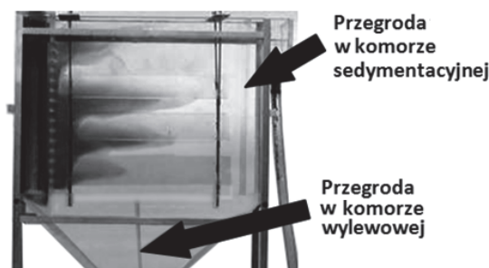
Rys. 7. Wizualizacja przepływu płynu zabarwionego markerem optycznym w osadniku z dwiema przegradami
