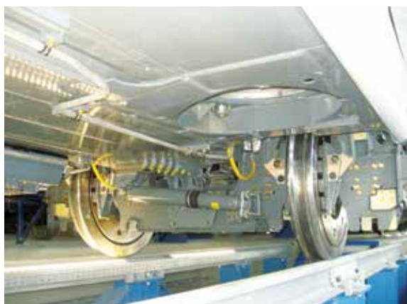
Nieprzestawny zestaw kołowy pociągu Talgo na torze 1520 mm. Fot. A. Leszkiewicz
