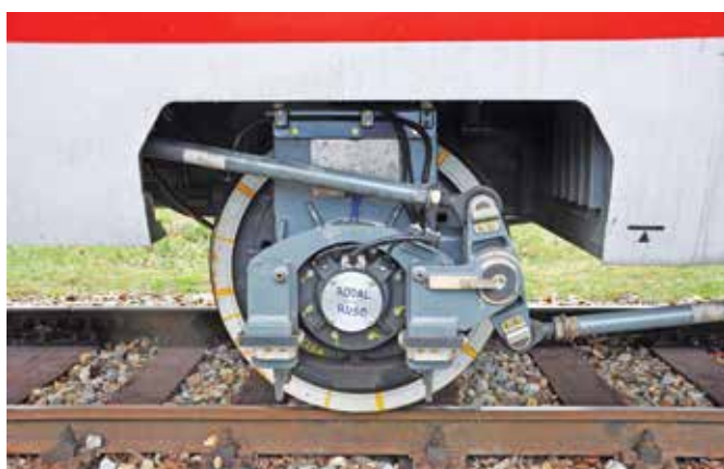
Skrajny zestaw kołowy pociągu Talgo w wagonie końcowym (technicznym). Fot. M. Graff
