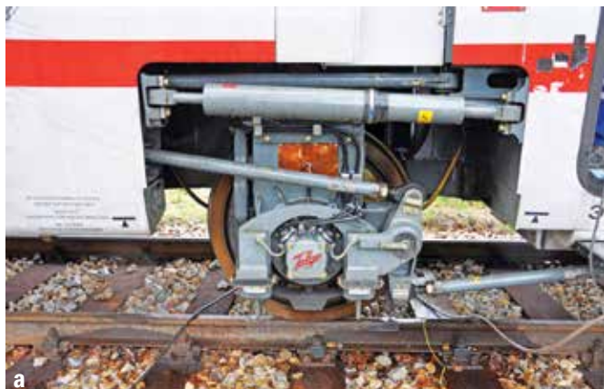
Zestaw kołowy pociągu Talgo: a) pomiędzy wagonem końcowym (technicznym) i sąsiednim, b) pomiędzy wagonami pasażerskimi. Fot. M. Graff
