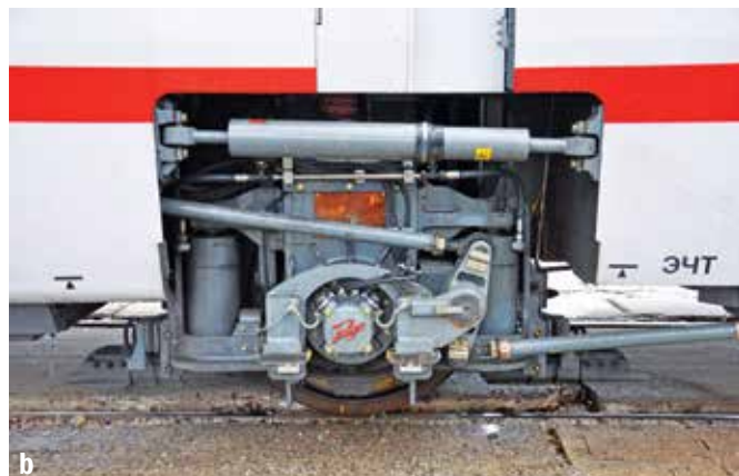
Zestaw kołowy pociągu Talgo: a) pomiędzy wagonem końcowym (technicznym) i sąsiednim, b) pomiędzy wagonami pasażerskimi. Fot. M. Graff
