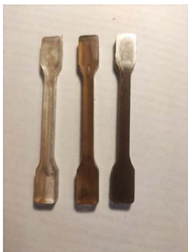
Rysunek 2. Od lewej: Próbkę z PC przetworzonego jednokrotnie, dwukrotnie oraz czterokrotnie
