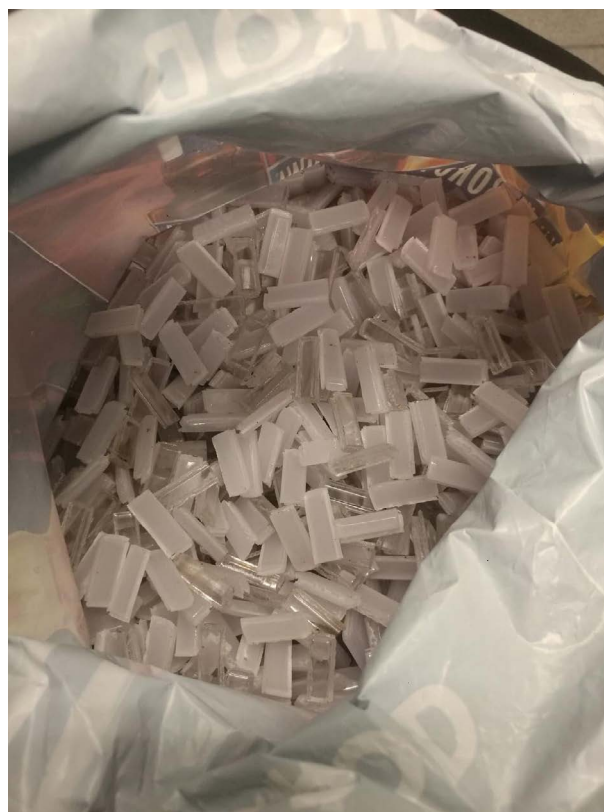
Rysunek 1. Poliwęglan odpadowy, rozdrobniony i przygotowany do przetwórstwa
