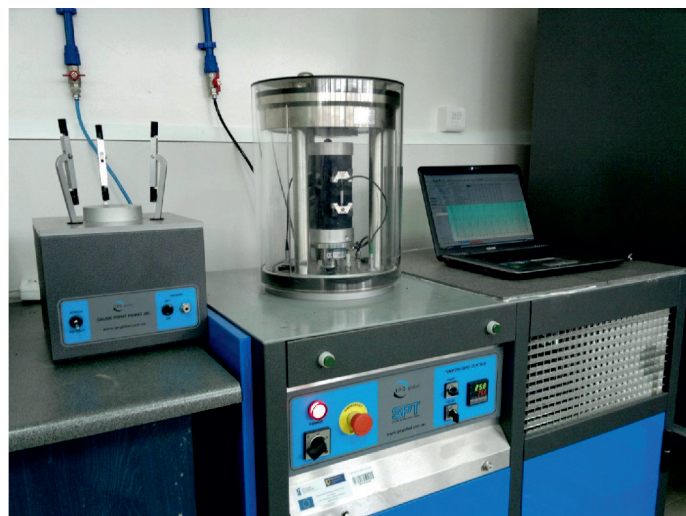
Rys. 2. Aparat AMPT/SPT ( Asphalt Mixture Performance Tester ) do badania mieszanek mineralno-asfaltowych – widok ogólny
