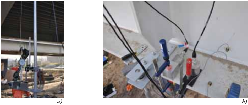
Fot. 2. Aparatura pomiarowa: a) czujnik indukcyjny do pomiaru ugięć, b) akcelerometry do pomiarów przyspieszeń w kierunku pionowym i poziomym
