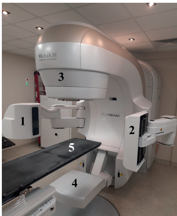
Ryc. 1 Akcelerator terapeutyczny TrueBeam (Varian Medical Systems, Palo Alto, USA) z zaznaczeniami: 1 – lampa kV; 2 – detektor promieniowania kV; 3 – głowica akceleratora; 4 – detektor promieniowania MV (EPID); 5 – stół terapeutyczny Źródło: Własne.
