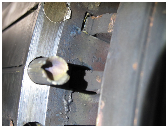
Rys. 5. Uszkodzona klatka wirnika, widok po obcięciu pierścienia zwierającego klatki rozruchowej – widoczne wytopienie pręta klatki rozruchowej
