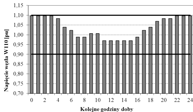
Rys. 6. Zmiana poziomu napięcia w węźle W110 przy naturalnym tgφ (brak kompensacji mocy biernej)
