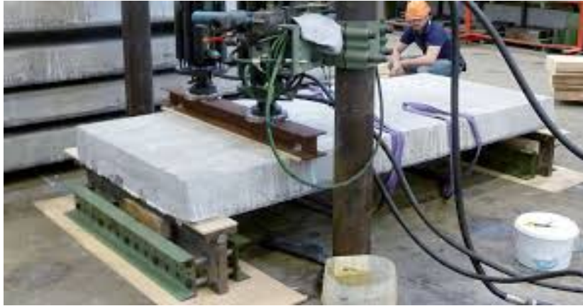
Rys. 4. Badanie wytrzymałości na ścinanie stropu [6].
