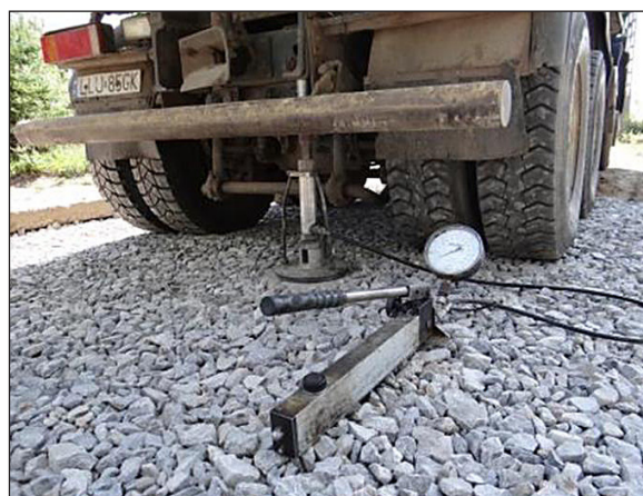
Rys. 5. Badanie nośności warstwy aeracyjnej Fig. 5. Testing the load capacity of the aggregate layer aeration layer
