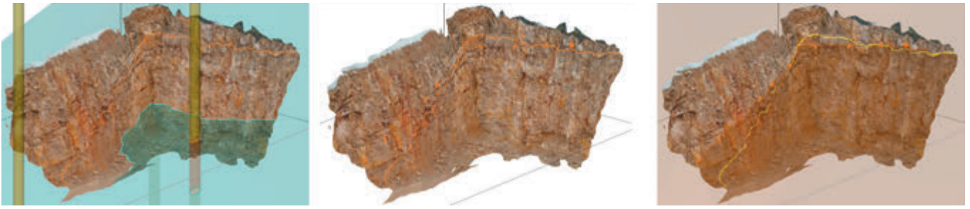
Rys. 5. Proces dokumentowania budowy geologicznej i aktualizacji modelu złoża z wykorzystaniem metody fotogrametrii cyfrowej Fig. 5. Geological structure documentation process and upgrading of the bed model using digital photogrammetry
