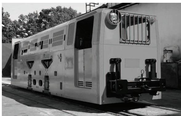
Rys.11. Lokomotywa z napędem spalinowym Lds-100K-EMA [10]
