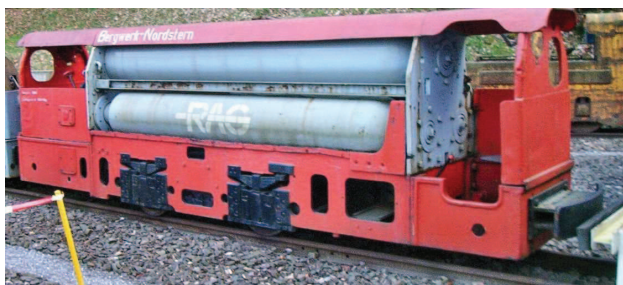
Rys. 1. Lokomotywa z napędem pneumatycznym Jung PZ 45 [14]
