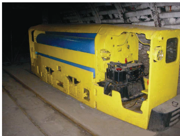
Rys.2. Lokomotywa z napędem pneumatycznym BVD 40 [15]
