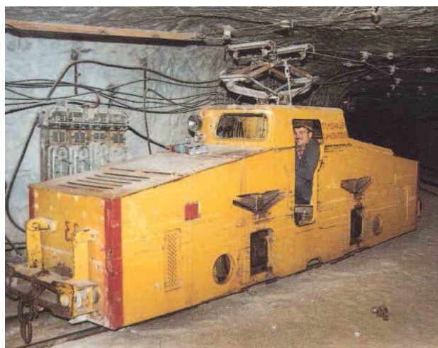
Rys.5. Lokomotywa dołowa z napędem elektrycznym Ld-31 [7]
