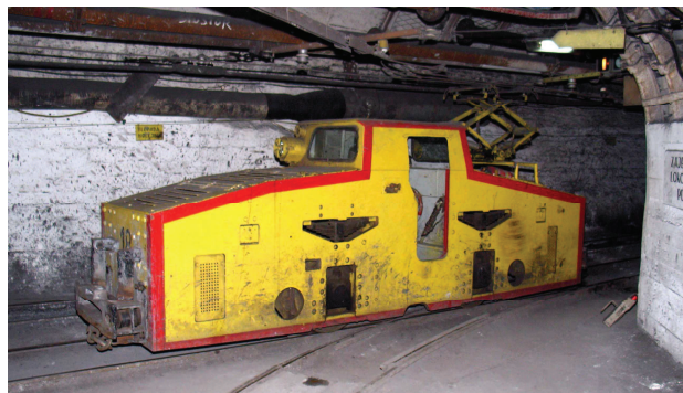
Rys.4. Lokomotywa dołowa z napędem elektrycznym Ld-21 [5]
