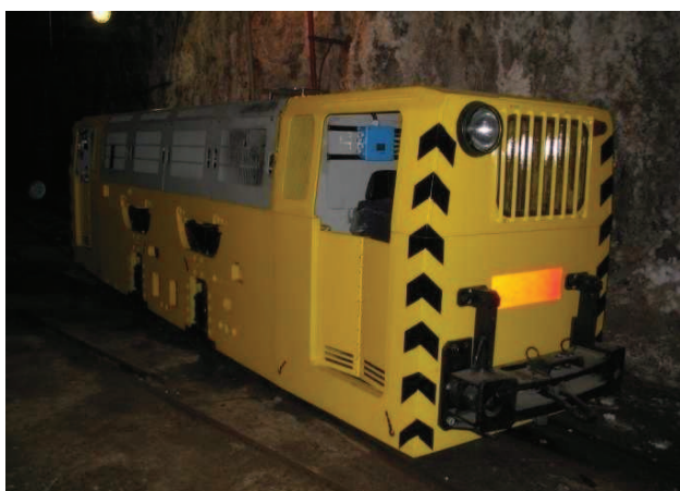
Rys.10. Lokomotywa z napędem spalinowym Lds-100K-EM [10]
