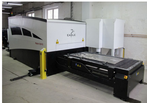
Rys. 2. Wycinarka laserowa Eagle eVision 1225
