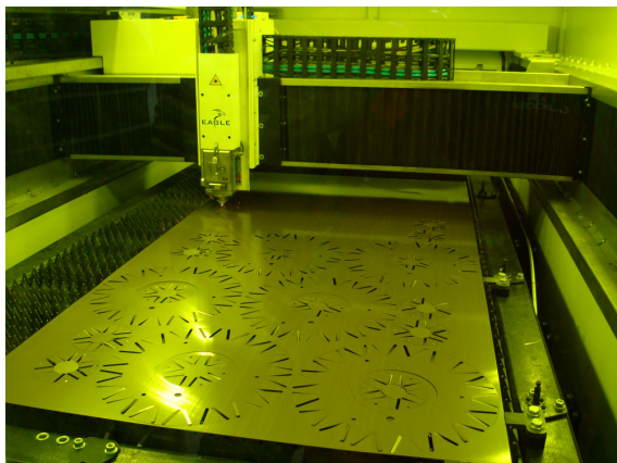
Rys. 5. Wnętrze wycinarki laserowej
