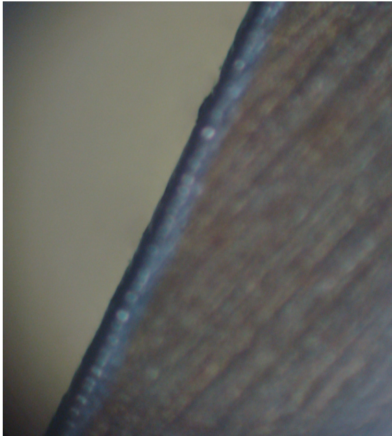
Rys. 6. Blachy wycięte laserem technologią FIBER
