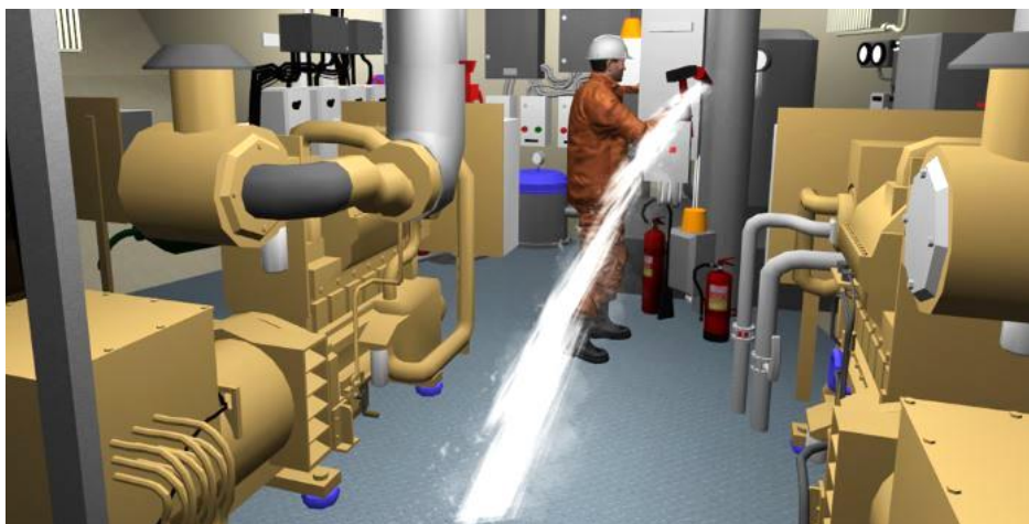
Rys. 3. Awaria rurociągu wodnego na okręcie. Źródło: Archiwum foto Autocomp Management Sp. z o.o.
