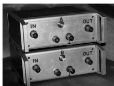
Rys. 2. Sztuczne sieci pomiarowe zgodne z wytycznymi zawartymi w normie [2] Fig. 2. Line impedance stabilization networks compatible with the standard [2]
