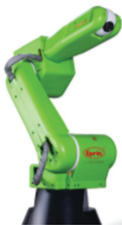
Rys. 4. Robot współpracujący CR-35iA firmy Fanuc [10] Fig. 4.. Fanuc collaborative robot CR-35iA [10]
