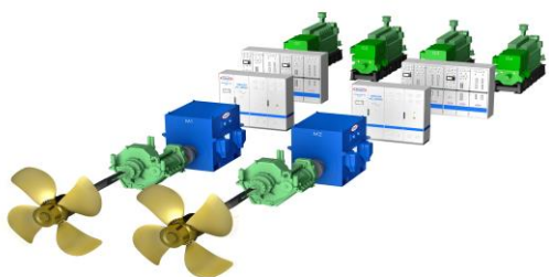
Rys. 1. Napęd spalinowo elektryczny ze śrubą konwencjonalną [15]
