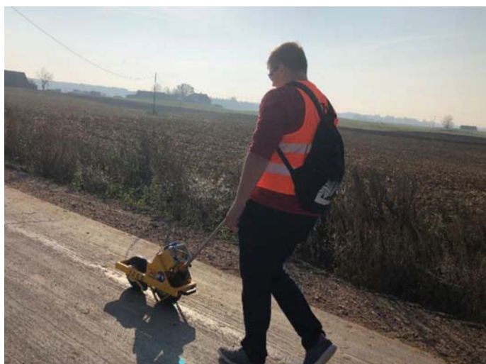
Fot. 3. Pomiar współczynnika tarcia urządzeniem T2Go na odcinku testowym (fot. M. Wasilewska)
