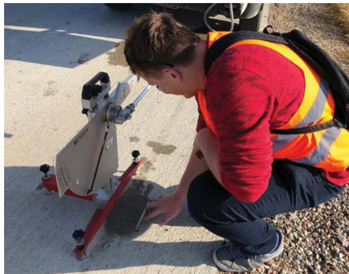
Fot. 4. Pomiar PTV wahadłem angielskim (fot. M. Wasilewska)
