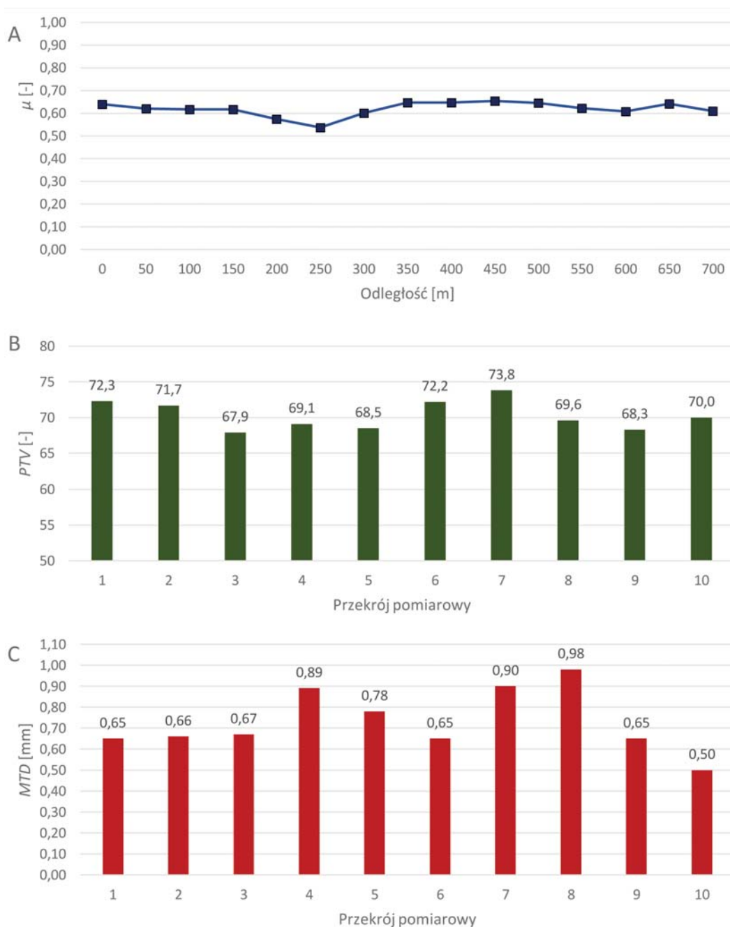
Rys. 2. Wyniki pomiarów na odcinku OT-2 A) współczynnik tarcia \mu , B) wartość PTV, C) parametr MTD
