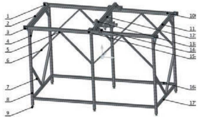
Rys. 4. Schemat ramy nośnej z wykazem elementów składowych [8]
