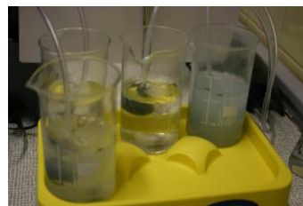
Rys. 1. Stanowisko pomiarowe do badania procesu biodegradacji w środowisku wodnym
