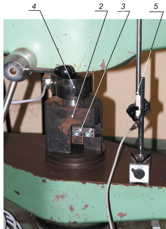
Rys. 3. Widok stanowiska badawczego do badania kołków zabezpieczających, gdzie: 1 – maszyna wytrzymałościowa, 2 – przyrząd ustalająco-ścinający, 3 – kołek zabezpieczający ścinany, 4 – czujnik siły, 5 – czujnik przemieszczenia, 6 – cyfrowy moduł pomiarowy A/C, 7 – komputer
