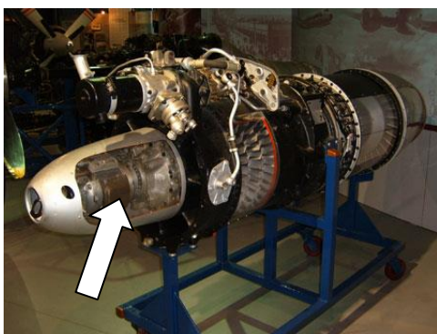
Rys. 3.10. Silnik BMW-003 z dwusuwowym silnikiem rozruchowym [17]
