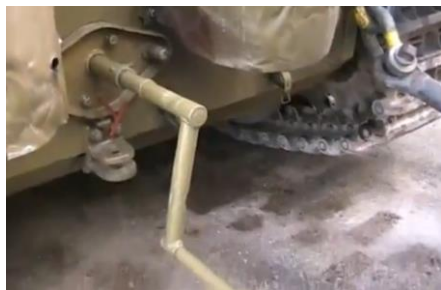
Rys. 3.4. Korba napędzająca rozrusznik inercyjny silnika czołgu typu PzKpfw VI [11]
