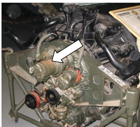
Rys.3.3. Układ rozruchowy silnika gwiazdowego czołgu M3 Stuart [15]
