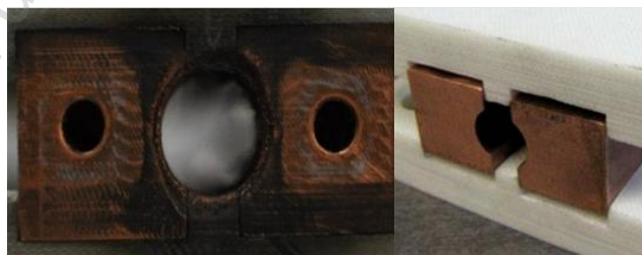
Rys. 2. Z lewej strony widok szyn modułu napędowego typu rail-gun: widoczne uszkodzenia na skutek zjawiska elektroerozji; po prawej widok nowego szynowego modułu napędowego hybrydowej wyrzutni elektromagnetycznej
