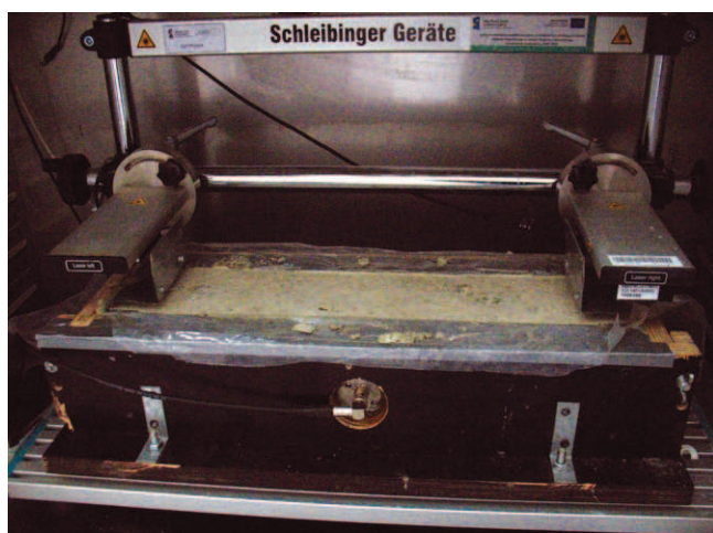
Rys. 1. Urządzenie do pomiaru zmian długości belek betonowych
