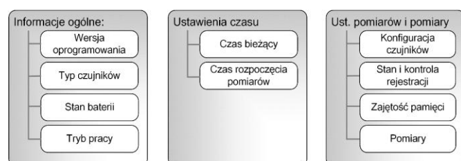
Rys. 6. Struktura profilu GATT czujnika w standardzie BT4.0LE
