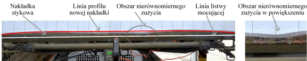
Rys. 3. Widok profilu nakładki stykowej o nierównomiernym zużyciu, dodano linie pomocnicze profilu i listwy nakładki [fot. S. Judek]
