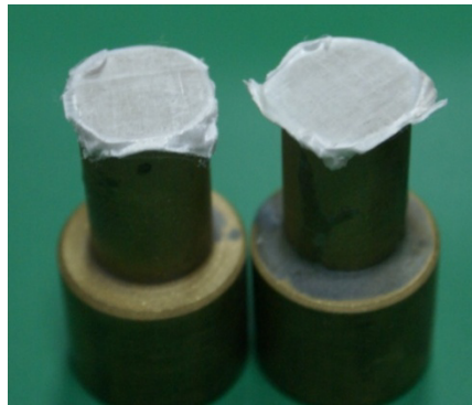
Rys. 6. Przykład rozwarstwienia tkaniny podczas próby montażu próbki w uchwytach maszyny wytrzymałościowej
