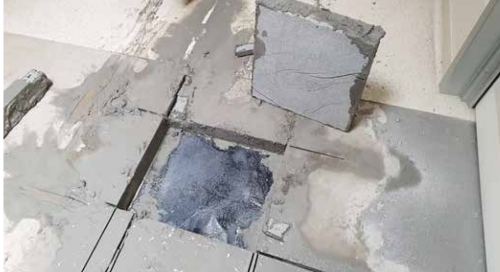
Wycięta tafła warstwy podkładu do przygotowania beleczkowych próbek do badania
