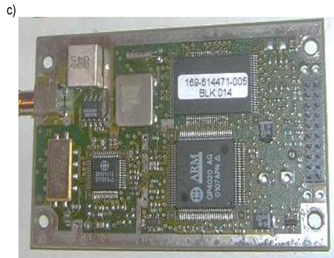
Rys. 3 Komunikacja tramwaju z ITS; a) Tramwaj wyposażony w radio GPRS (na dachu tramwaju widoczna antena radia), b) Kokpit tramwaju wyposażonego w komputer służący do komunikacji z centralą ITS, c) Lokalizator GPS. [opracowanie własne]
