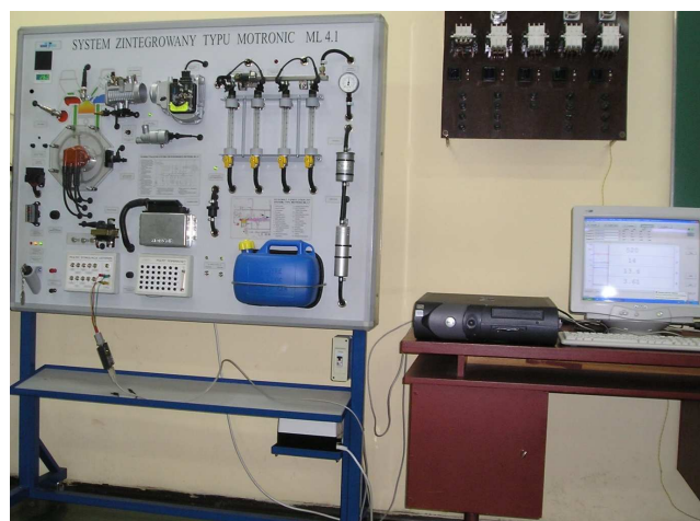
Rys. 5. Stanowisko laboratoryjne do badania przesyłania informacji w sieci wewnętrznej w systemie sterowania silnikiem benzynowym typu Motronic
