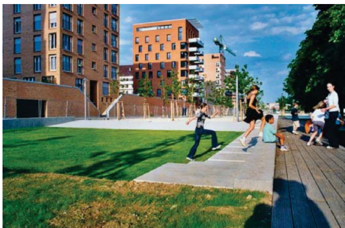
Fot. 12. Fragment parku będący na co dzień suchym zbiornikiem, zapełniającym się wodą podczas intensywnych opadów deszczu [29]
