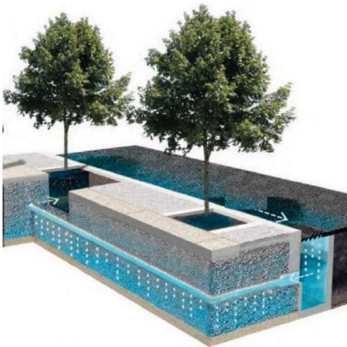
Rys. 3. Schemat działania zadrzewionej muldy w linii chodnika dla pieszych [12]
