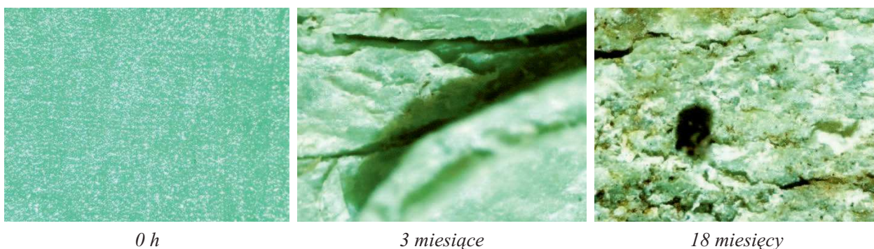
Rys. 14. Zamiana wyglądu powierzchni próbki numer 10 (PLA 100%) po określonym czasie starzenia w kompoście naturalnym
