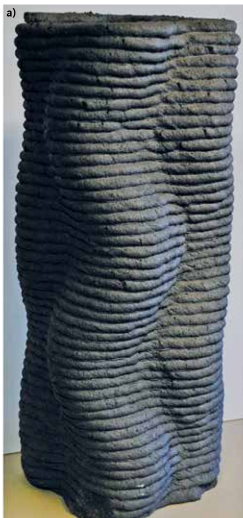
Rys. 3. Elementy o skomplikowanej geometrii wykonane w technologii druku 3D na Zachodniopomorskim Uniwersytecie Technologicznym w Szczecinie a) słup o skomplikowanym kształcie b) doniczka
