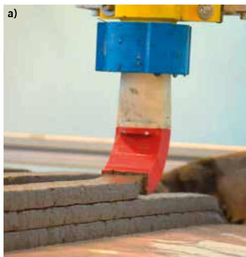
Rys. 1. Przykłady druku 3D kompozytu cementowego metodą wytłaczania a) wydruk ścieżki wielowarstwowej b) zgrubienie na początku ścieżki – efekt wypływu kompozytu z dyszy bez zaworu
