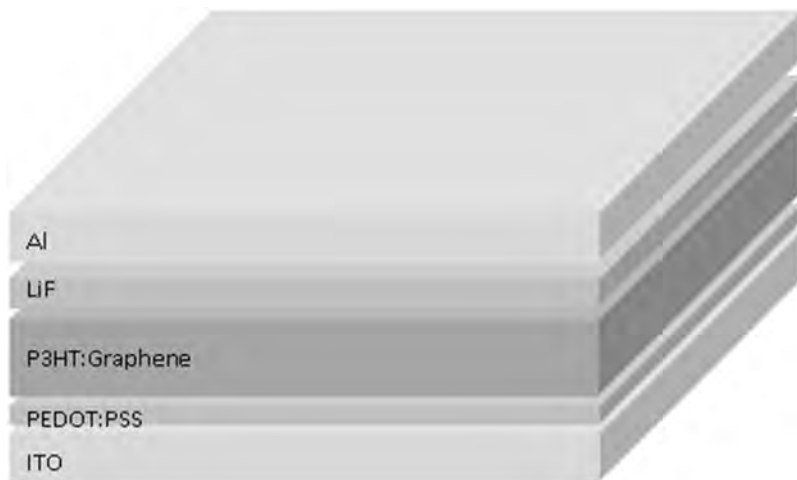
Rys. 2. Schemat struktury urządzenia z cienką warstwą grafenu jako warstwa aktywna (ITO/PEDOT:PSS(40 nm)/P3HT:SPFGraphene (100 nm)/LiF (1 nm)/Al (70 nm)) [29]
