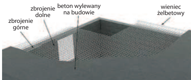
Rys. 5. Budowa stropu monolitycznego (źródło: opracowanie własne)
