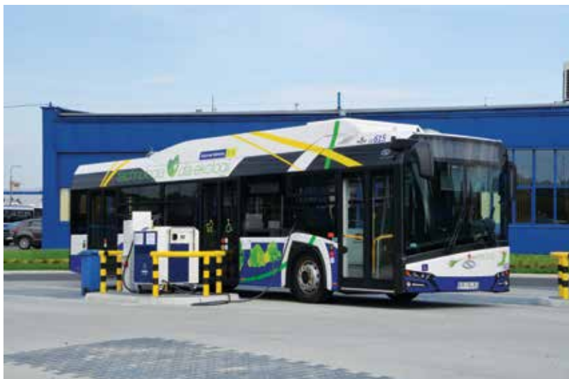
Solaris Urbino 12 electric dla MPK Kraków na stacji uzupełniania energii elektrycznej z ładowarką MEDCOM. Fot. MEDCOM
